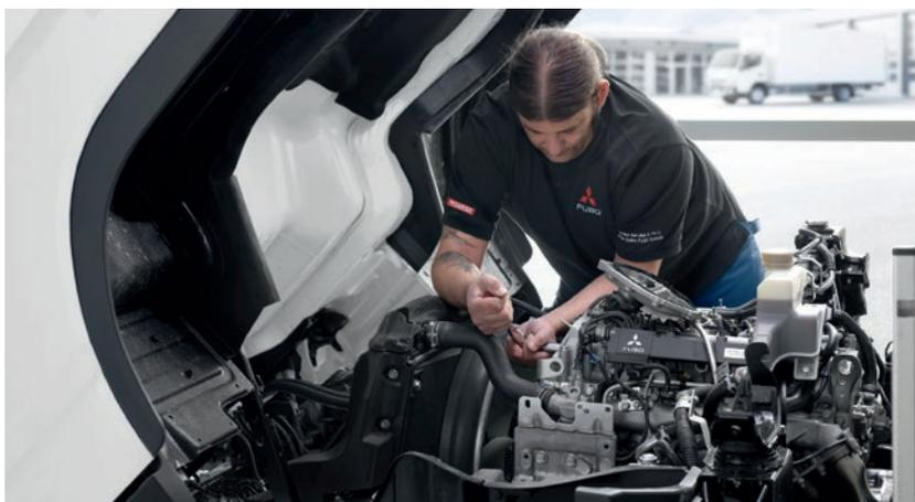
**Wartungsumfänge.** Trotz der strengeren Abgasnorm Euro VI konnten die Wartungsintervalle bei 40.000 km (bzw. einmal pro Jahr) stabil gehalten werden. Regelmäßige Wartungspunkte (Ölstands-, Bremsflüssigkeits- und Waschwasserkontrolle) liegen innerhalb des Fahrertraums, was eine leichte, schnelle und saubere Kontrolle gewährleistet. Unser kippbares Fahrerhaus (Einzelkabine) ermöglicht problemlosen Zugang zu allen Bauteilen des Motors.
