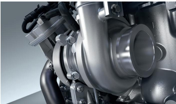
**VTG und serienmäßige Abgasbremse.** Die variable Turbolader-Geometrie (VTG) sorgt bereits bei geringer Drehzahl für ein optimales Ansprechen des Motors und ein gleichbleibend hohes Drehmoment. Die Abgasbremse schützt die Bremsbeläge und -scheiben Ihres Fahrzeugs; bei langen Bergabfahrten wird das Bremssystem entlastet.
