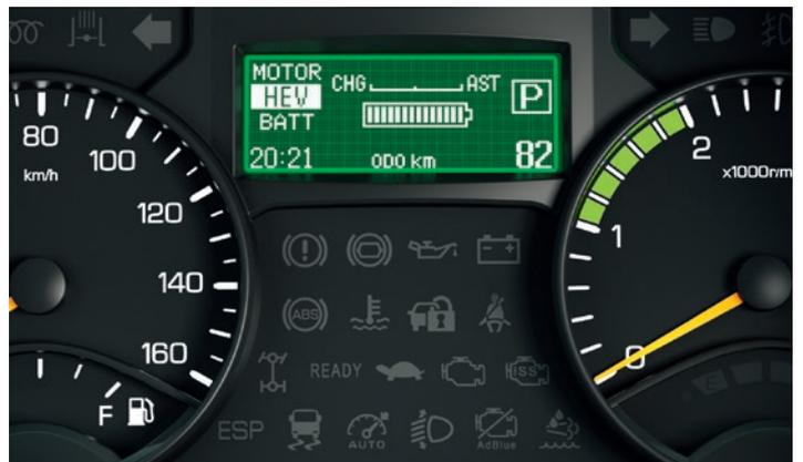
**Hybrid-Display.** Das gut lesbare Display zeigt dem Fahrer den aktuellen Ladezustand der Batterie. Zudem lässt sich durch die Energy-Flow-Anzeige nachvollziehen, wann Energie verbraucht bzw. zurückgewonnen wird. So kann das Fahrverhalten immer weiter optimiert werden.
