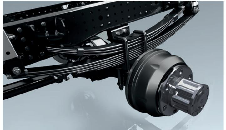
**Das Bremssystem.** Anpackend auf der Straße, größtmögliche Verzögerung, wenn es etwas anspruchsvoller wird. Gut geschützt gegen Staub und Dreck: Die Trommelbremsen vorne und hinten verzögern gleichmäßig mit ABS und elektronischer Bremskraftverteilung (EBD).
