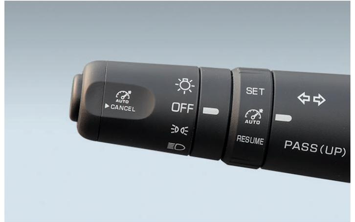
**Die Cruise Control Funktion.** Sorgt für die Einhaltung eines konstanten Fahrtempos oder verhindert das Über- bzw. Unterschreiten von Geschwindigkeitsbegrenzungen. Für entspanntes Fahren vor allem auf längeren Strecken. Optional für alle Modelle mit dem Doppelkupplungsgetriebe DUONIC® 2.0 erhältlich – außer für den Canter Eco Hybrid.
