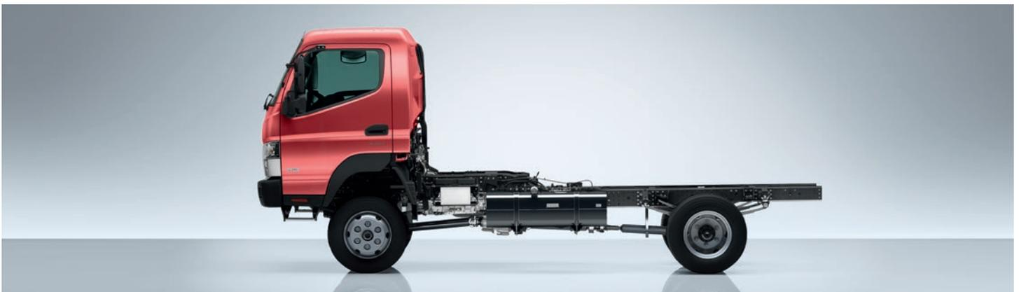
**Die Nutzlast.** Der Canter 4x4 verfügt über eine Fahrgestelltragfähigkeit von bis zu 3.685 kg. Durch die Achslasten von bis zu 6 t sowie eine optionale 24-V-Schnittstelle und Nebenantriebe ab Werk lassen sich vielfältige Aufbau­lösungen realisieren.
