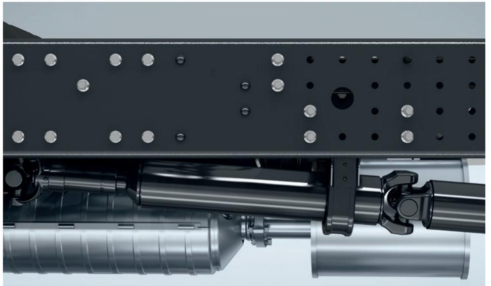
**Der Rahmen – robust und flexibel zugleich.** Das durchgängige Lochbild des Leiterrahmens für alle Modelle macht den Canter besonders variabel und aufbaufreundlich. Auch die optionale 24-Volt-Schnittstelle sowie verschiedene ab Werk verfügbare Nebenabtriebe für den Antrieb von Hydraulikpumpen oder Kompressoren sorgen dafür, dass der Canter für alles zu haben ist.
