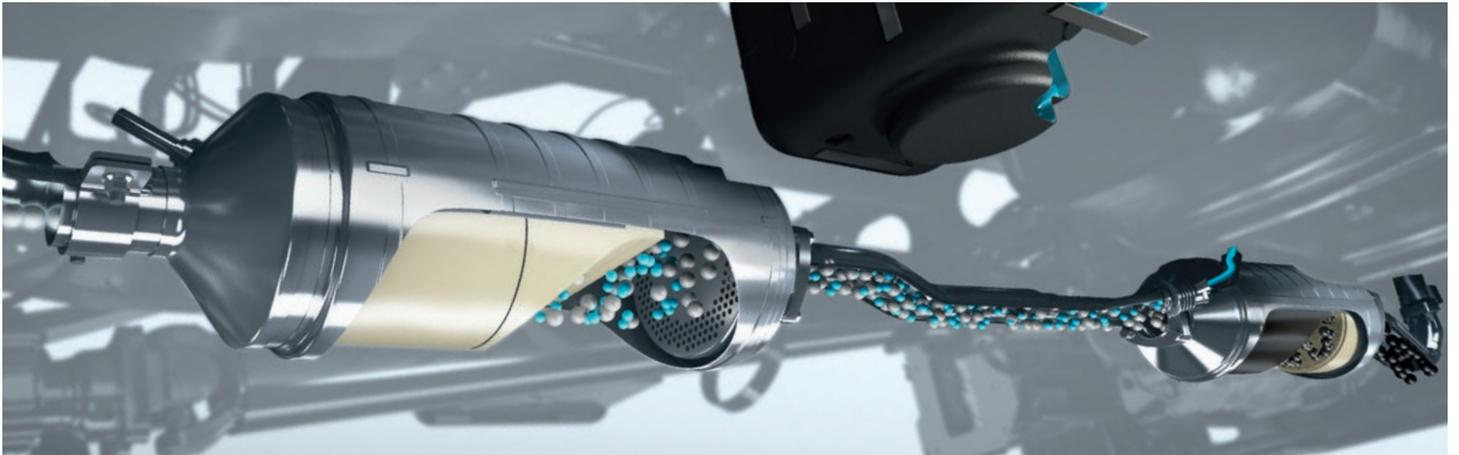
**Das Abgasreinigungssystem.** Alle Motorvarianten verfügen über einen geschlossenen und wartungsfreien Dieselpartikelfilter, der sich automatisch regeneriert. Bei Bedarf kann das auch manuell geschehen. Die Kombination aus Oxidationskatalysator und Dieselpartikelfilter reinigt also die Abgase. Zusätzlich kommt BlueTec® 6 zum Einsatz. Somit erfüllen alle Canter Modelle die Euro VI Norm.
