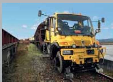
UNIMOG bis 1000 t Anhängelast
