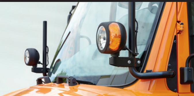
Exakt auf den Unimog abgestimmt: Die Zusatzscheinwerfer-Erhöhung erlaubt die optimale Ausleuchtung der Fahrbahn und erhöht so maßgeblich die Verkehrssicherheit – besonders beim Arbeiten mit Frontanbaugeräten.
