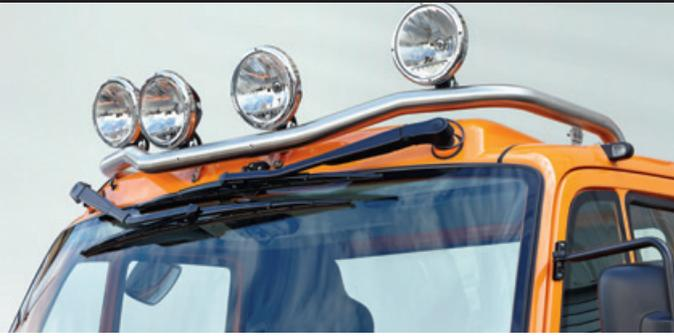
Dachlampenträger für beste Sicht auf Fahr- und Arbeitsfläche. Wahlweise für bis zu 4 Scheinwerfer in Fahrtrichtung. Oder eine Kombination von Fern- und Arbeitsscheinwerfern vorn sowie Arbeitsscheinwerfern und Rundumkennleuchte hinten. Im exklusiven Edelstahl-Design.
