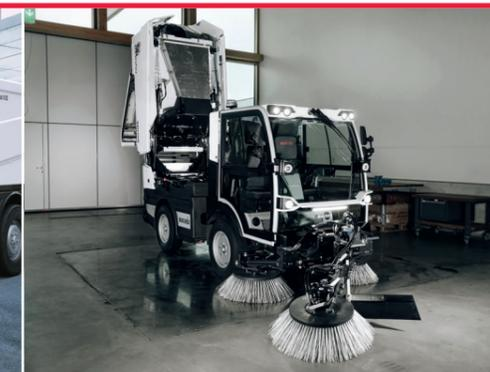
2 m<sup>3</sup>, einfach zu reinigender Kehrgutbehälter
