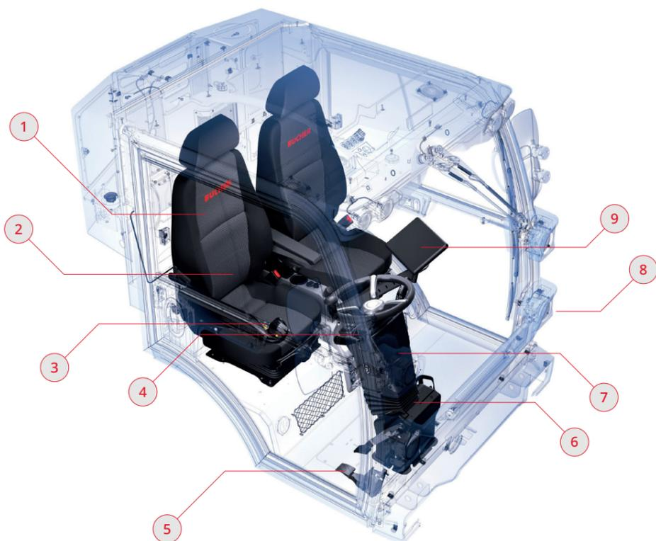
**1** Zwei vollwertige Sitze mit Kopfstütze und 3-Punkt-Sicherheitsgurten für Fahrer und Beifahrer bieten ein komfortables, sicheres Fahrerlebnis
