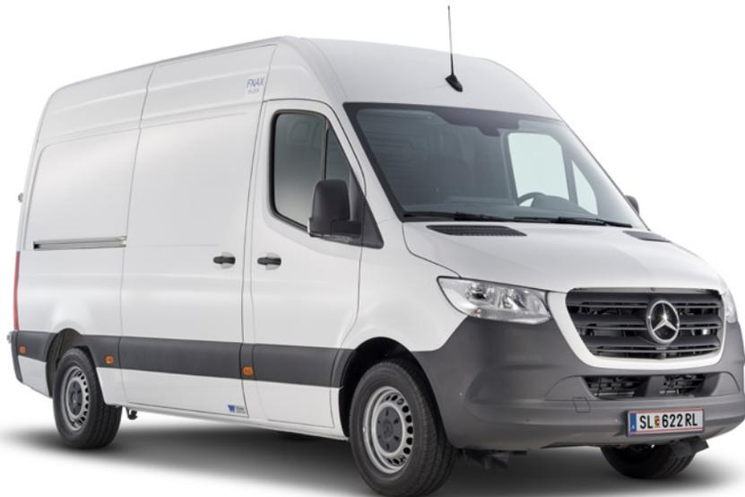
Der Sprinter mit Kühlhausbau von Winter verzichtet nicht auf Komfort, dafür auf einen zusätzlichen Dachaufbau – dank der integrierten Kühlanlage. Das macht ihn besonders aerodynamisch und spart Kraftstoff. Die kompressorbetriebene Kühlmaschine ermöglicht eine Kühlung bis zu 0 °C.
