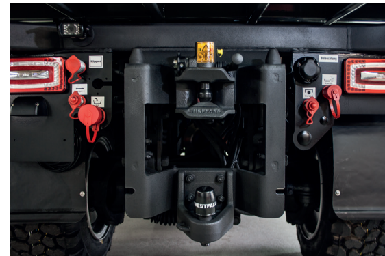
Schwere Anbautraverse zur Aufnahme von Heckanbaugeräten // Lifting beam for picking up rear mounted equipment
