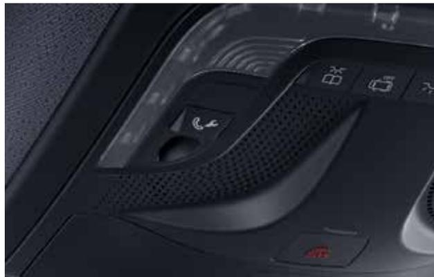
Rasche Pannenhilfe per Knopfdruck: Das Pannenmanagement stellt eine Sprachverbindung mit dem Customer Assistance Center (CAC) her und ermöglicht schnelle Hilfe vor Ort.
