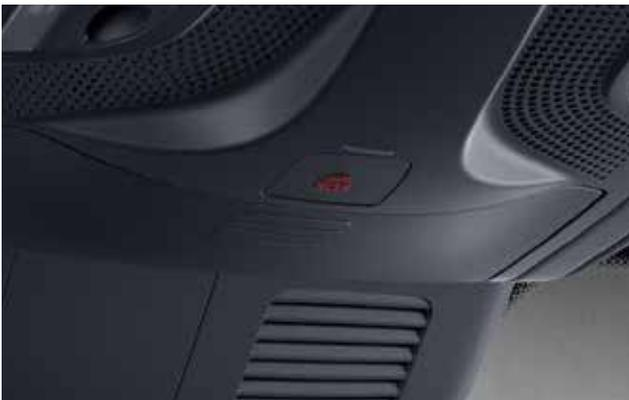
Bei einem Unfall setzt das Mercedes-Benz Notrufsystem automatisch einen Notruf ab und kann dadurch helfen, die Zeit bis zum Eintreffen der Rettungskräfte an der Unfallstelle entscheidend zu verkürzen.
