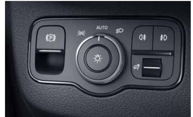
Die elektrische Feststellbremse lässt sich per Tastendruck einfach und bequem bedienen und ermöglicht durch den Entfall des Feststellbremshebels einen besseren Durchgang nach hinten.
