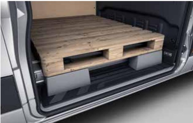
Die Palettenabstützung in der Trittstufe der Schiebetür stabilisiert das Ladegut im Türbereich und ist insbesondere beim Transport von Europaletten oder Gitterboxen sinnvoll.
