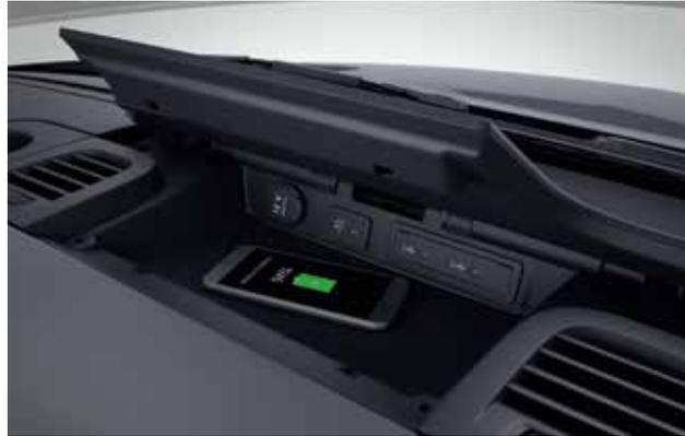
Dank kabellosem Ladesystem können mobile Endgeräte, die den Qi-Standard 1.2 unterstützen bzw. dafür nachrüstbar sind, in der mittleren oberen Ablage der Mittelkonsole ganz einfach aufgeladen werden.
