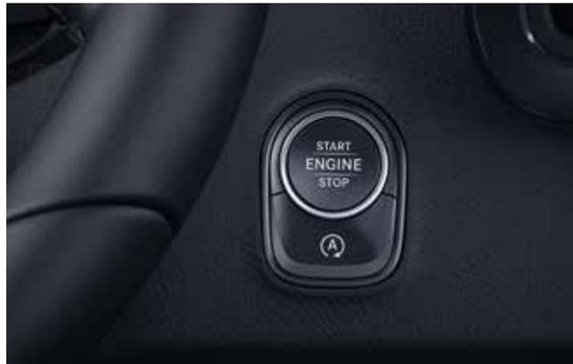
Den Motor einfach auf Knopfdruck anlassen: Das Fahrberechtigungssystem KEYLESS-START ermöglicht das Anlassen des Motors allein durch Drücken der Start-Stopp-Taste im Zündschloss.
