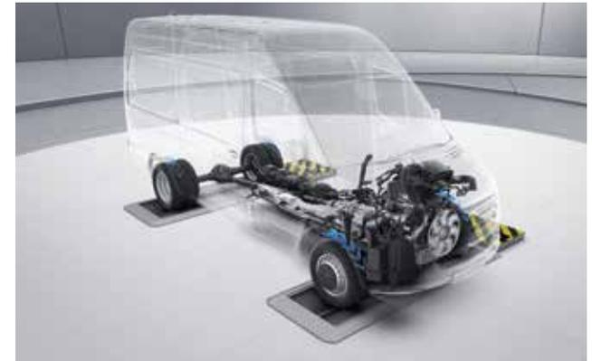
Vorderrad-, Hinterrad- oder Allradantrieb<sup>1</sup> – mit den 3 Antriebsvarianten für den Sprinter findet sich wohl für nahezu jede Transportaufgabe und für nahezu jedes Fahrprofil der passende Antrieb.
