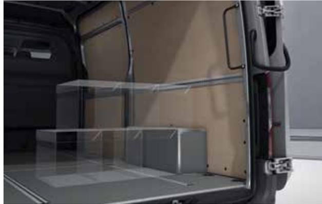
Die Holzverkleidung der Radeinbauten verbessert die Beladbarkeit des Laderaums und schützt das Blech vor Beschädigung.
