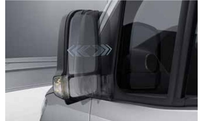
Die elektrisch heranklappbaren Außenspiegel sind bei engen Ein- und Ausfahrten oder während des Parkens im angeklappten Zustand besser vor Beschädigungen geschützt.
