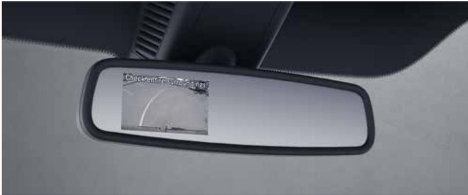
Die Rückfahrkamera mit Innenspiegelanzeige verbessert die Sicht auf den Bereich direkt hinter dem Fahrzeug und erhöht die Sicherheit beim Rückwärtsfahren.
