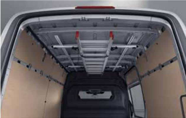
Der Dachgepäckträger<sup>1</sup> im Laderaum schützt Ladegut im Vergleich zu außen angebrachten Dachträgern besser vor Verschmutzung und Diebstahl.
