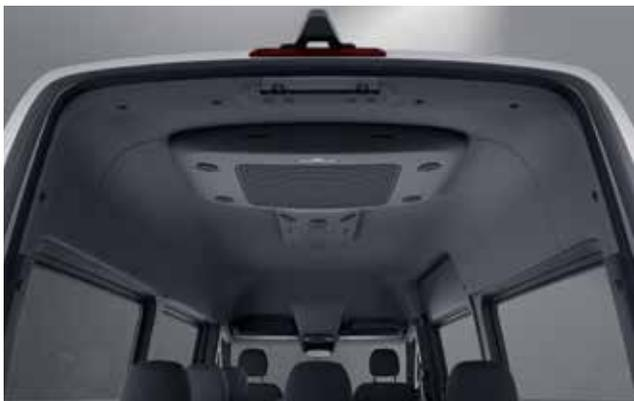
Die Hochleistungsdachklimaanlage ergänzt die Klimaanlage vorn mit 11 kW zusätzlicher Kühlleistung und sorgt für höchsten Klimakomfort im Fahrgastraum, besonders bei sehr heißen Temperaturen.
