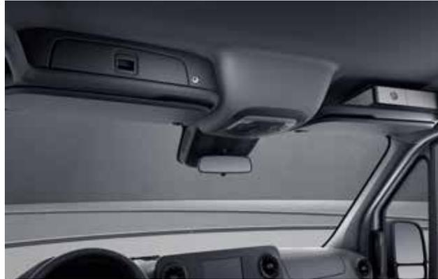
Das bequem erreichbare, abschließbare Fach auf der linken Seite in der Ablage über der Frontscheibe ermöglicht das sichere Verstauen wichtiger Gegenstände.
