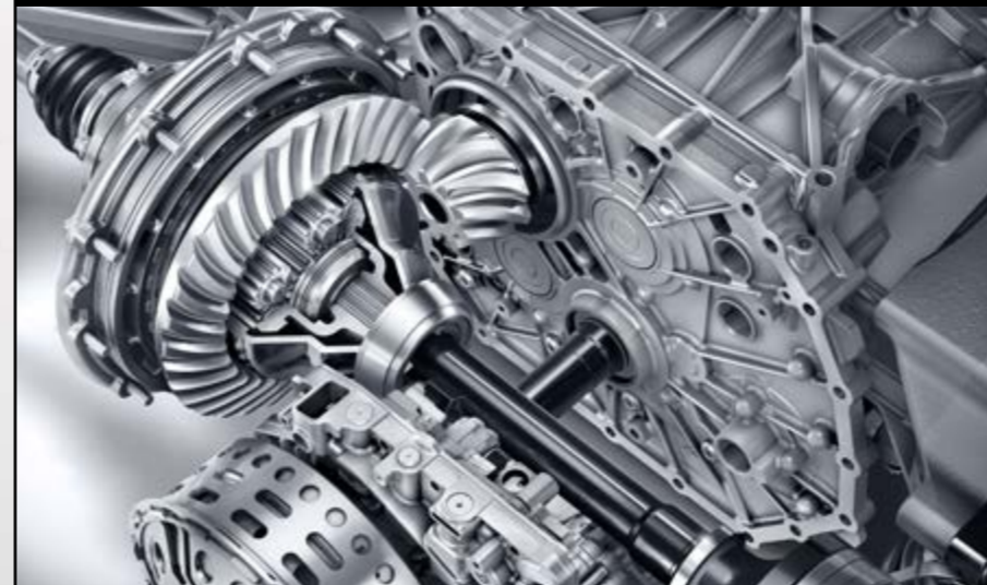
467 – AMG elektronisches Sperrdifferential Hinterachse
