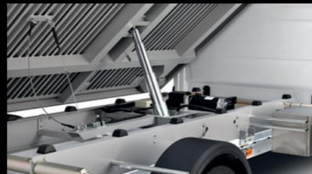
**Elektrisch betriebene Kipphydraulik** sorgt mit Hydro-Elektro-Aggregat und voll verchromtem Hydraulikzylinder für den nötigen Auftrieb. Der Profilblechboden bietet optimale Stabilität.
