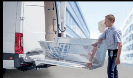
**Klappbare Bordwand.** Durch die klappbare Bordwand jederzeit schneller Zugang über die rechte Hecktür.
