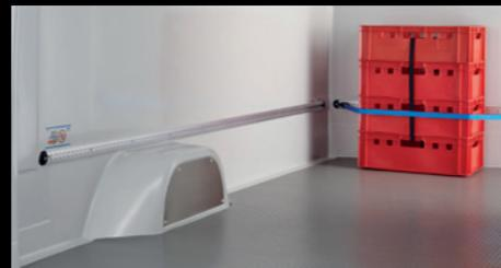
**Airline-Schienen im Kühlfrachtraum**, rundumlaufend, für die Ladungssicherung mit Spanngurten und Sperrstangen.
