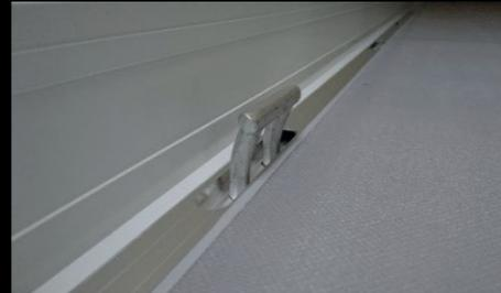
**Zurrösen am Ladeboden,** seitlich versenkt, zur individuellen Ladungssicherung.
