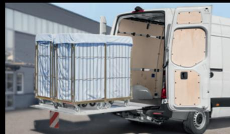
**Plattform.** Diese ist im ausgeklappten Zustand ca. 1.810 x 1.330 mm (L x B) groß und bietet Platz für bis zu vier Rollwagen.
