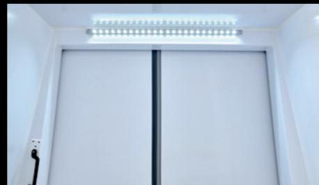
**LED-Laderaumleuchte** für eine optimale Ausleuchtung des Laderaums.
