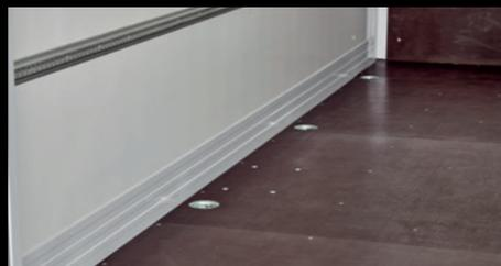
**Belastbarer Holzfußboden**, 15 mm, rutschhemmende u. kratzunempfindliche Oberfläche. Stabile **Sockelscheuerleisten** schützen die Aufbauwände vor Beschädigungen durch das Ladegut.
