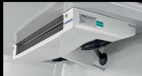
**Integriertes Kühlaggregat.** Die kompressorbetriebene Kühlmaschine kühlt bis zu 0 °C. Aerodynamisch günstig positioniert, unterflurmontiert, kraftstoffsparend.
