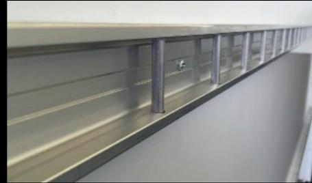
**Stäbchen-Zurrschienen aus Aluminium** (zwei Reihen) an den Seitenwänden, auftragend montiert zur Ladungssicherung.
