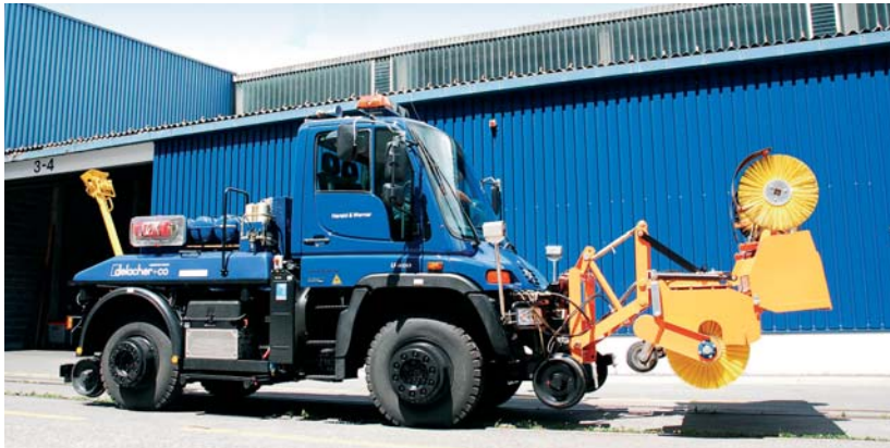
Auch zur Gleiserhaltung ist der Unimog im Einsatz.
