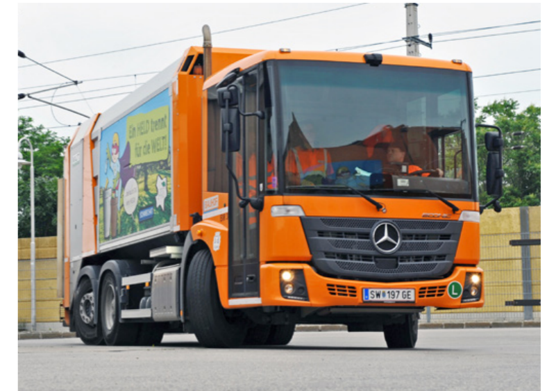
Drei Achsen sorgen beim Econic für einen erheblichen Lastvorteil.
