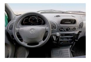
allem der neue Schalthebel in Form eines Joysticks ins Auge. Er ragte jetzt griffgünstig aus der Mittelkonsole und erlaubte einen völlig freien Durchgang im Fahrerhaus.
