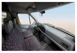
Zahlreiche Ablagen, darunter ein großzügig dimensioniertes, abschließbares Handschuhfach, erleichterten den Arbeitsalltag im Sprinter. Der Fahrersitz war zweimal in der Höhe verstellbar, damals im Transportersegment eine Sensation. Ein Novum waren ebenfalls die Drehregler für Heizung und Lüftung im Pkw-Stil inklusive eines kräftigen vierstufigen Gebläses und Umluftschaltung. Wohnliche Atmosphäre schufen auch die nahezu rundum verkleideten Wände und Türen. Der optionale Fahrer-Airbag,
