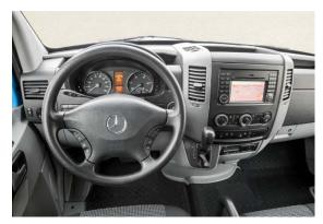
herausgehobene Mittelkonsole mit dem Joystick-Schalthebel. Als wertvolle Arbeitshilfe bot Mercedes-Benz für den Sprinter erstmals das Infotainmentsystem COMAND APS mit integriertem Navigationssystem an. Ebenfalls neu war das Multifunktionslenkrad.
