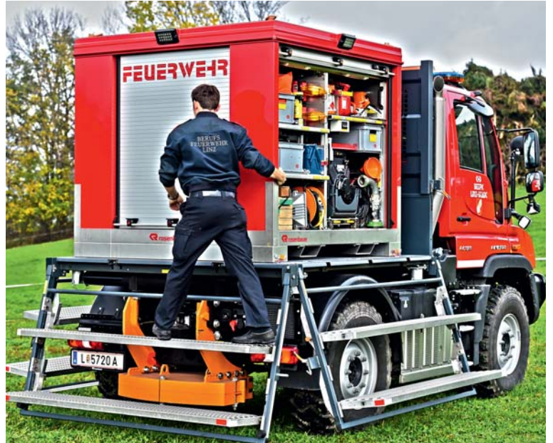
Doppelfunktion: Die heruntergeklappten Bordwände dienen gleichzeitig als Trittstufen.
