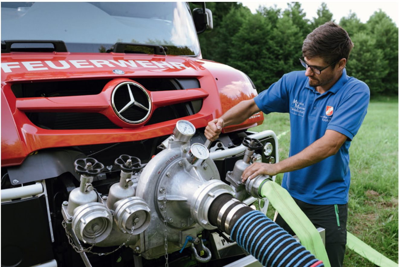
Über die Zapfwelle kann die Vorbaupumpe mühelos angetrieben werden. Auch hier wird der Unimog als universeller Alleskönner wieder seinem Namen gerecht.
