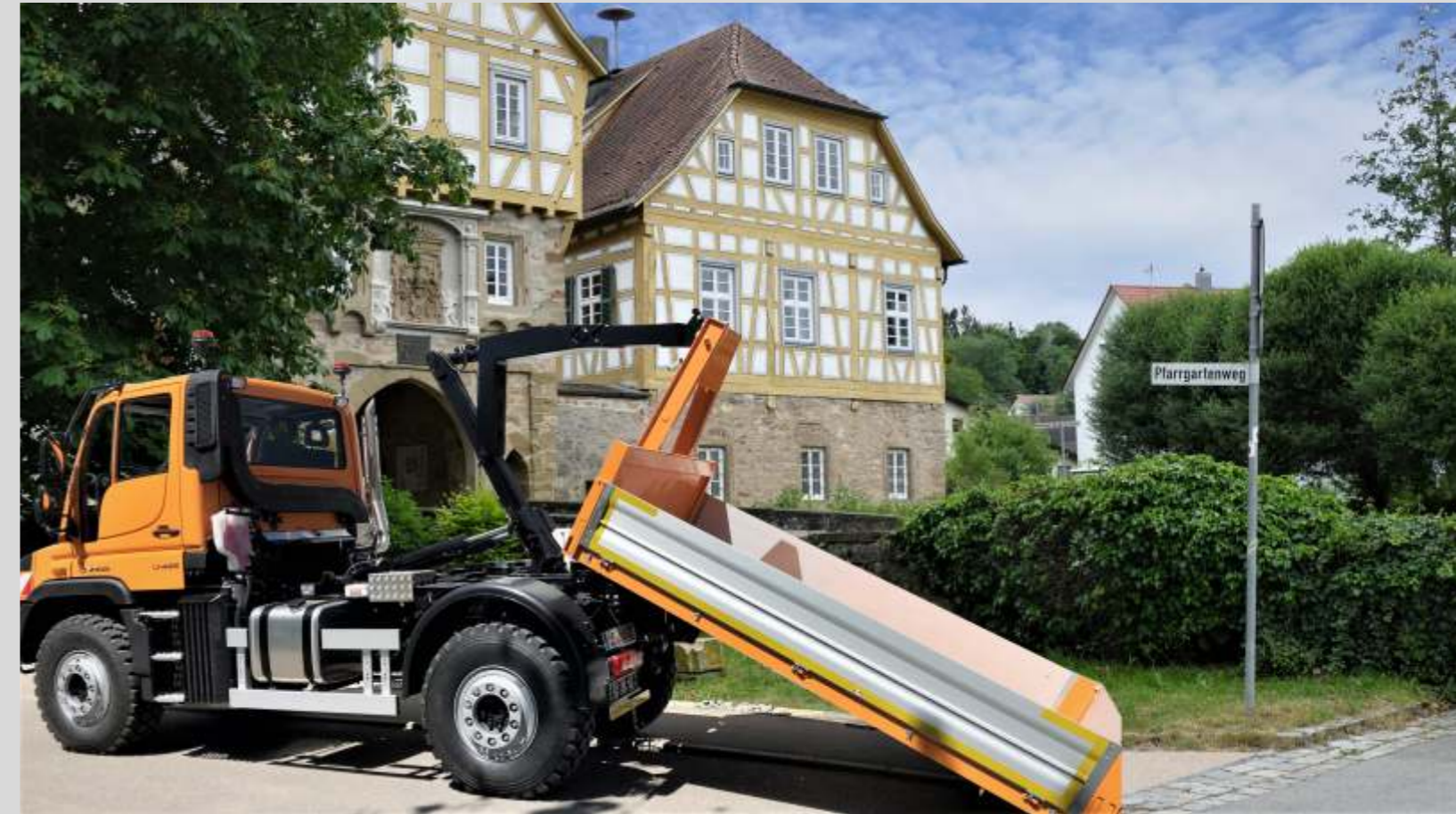
Aufziehrahmen für unterschiedliche Aufbauten wie z.B. Streugerät - Gießanlage - Thermobehälter Laubaufnahmebehälter - Schüttgutmulde-Maschinentransportplattform oder Baustelleneinrichtungen
