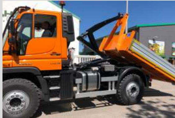
Flacher Abrollwinkel durch Knickarm mit integriertem Hydraulikzylinder
