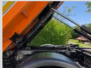
Hoher Kippwinkel um auch bei schwierigen Kippsituationen eine komplette Entleerung zu erreichen
