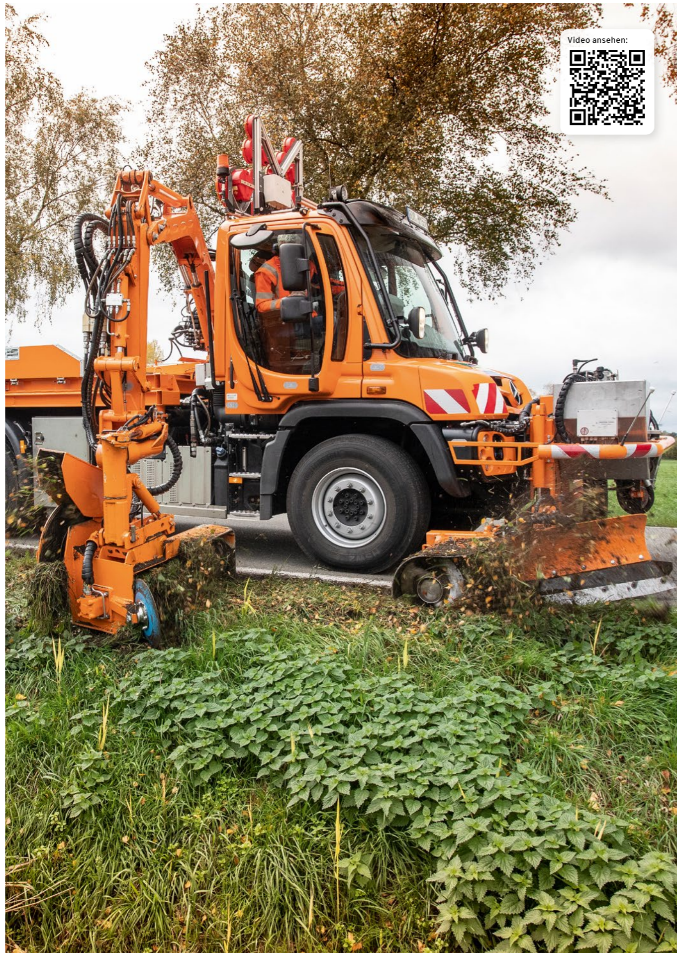
All in one: Landschaftspflege Hueske pflegt und erneuert Bankette mit dem Unimog in einem Arbeitsgang.
