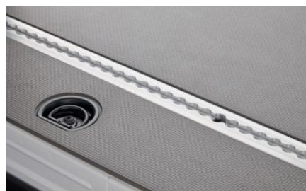
**Werksseitig installierte Zurrpunkte** bleiben erhalten und können, nach dem Hochklappen des Paketregals, zum Transport einer Palette oder größerer Güter zur Ladungssicherung verwendet werden.
