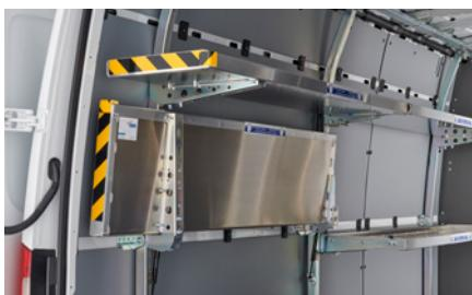
**Fest verbautes Regalsystem,** klappbar (links und rechts). Zeichnet sich durch seine sehr robuste und dennoch leichte Bauweise aus. Die Tragkraft der Regalböden kann dabei bis zu 80 kg/m betragen. Die Regalböden sind individuell und auf der linken Seite sogar segmentiert klappbar.
