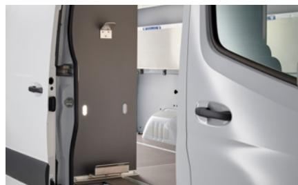
**Paketkarrenhalter** an zusätzlicher Trennwand (KA05), wird an der optionalen Trennwand, die sich hinter der Laderaumschiebetür befindet, montiert.
