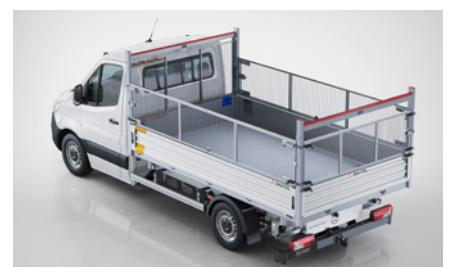
**Drahtaufsatzgitter seitlich und hinten, verzinkt (KD11)**, um loses Ladegut besser zu transportieren. Sie sind ca. 600 mm hoch.
