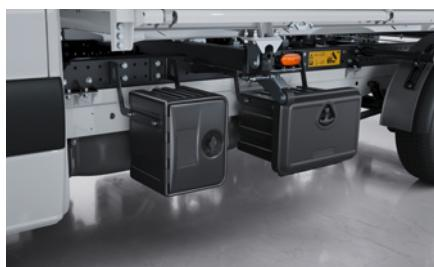
**Werkzeugkasten links (KM18)**, abschließbar, bietet zusätzliche Stau fläche für z. B. Verzurreinrichtungen oder Werkzeuge.
