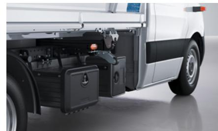
**Werkzeugkasten rechts (KM07)**, abschließbar, zur sicheren und geschützten Lagerung z. B. von Handwerksutensilien oder Spanngurten.
