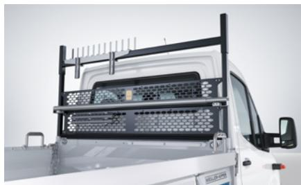
**Stirnwandpaket (KM16)** mit erhöhter Stirnwand mit Ablagegestell und individuell einstellbarem Stielgerätehalter für den Transport von Langgütern oder Arbeitswerkzeugen. Die Tragkraft des Ablagegestells beträgt 250 kg.
