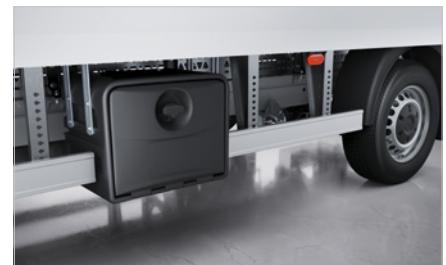
**Staukasten** (KS48), ist unterhalb des Kofferaufbaus am Fahrzeugrahmen und dient zur Aufbewahrung von Werkzeugen, Spanngurten oder anderen Utensilien.
