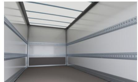
Zur Serienausstattung zählen abgerundete, stabile **Einfassprofile aus Aluminium**, die für Stabilität und eine optimierte Aerodynamik der Außenhülle sorgen, sowie das **lichtdurchlässige Dach** aus glasfaser-verstärktem Kunststoff (GFK).
