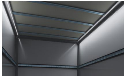
**LED-Lichtleiste anstelle der LED-Strahler** (KS61), leuchtet den Laderraum über die gesamte Länge besser aus.
