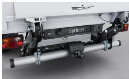
**Kugelkopfkupplung in Verbindung mit Ladebordwand** (KS41), ermöglicht bei Bedarf den Anhängerbetrieb in Kombination mit einer Ladebordwand.
