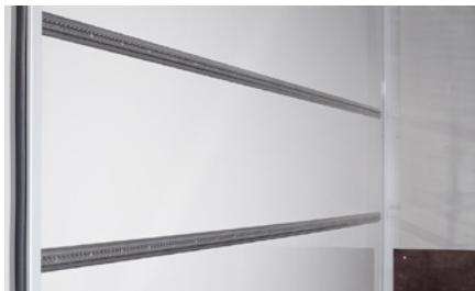
**Integrierte Airline-Schienen** auf einer Höhe von 600 mm und 1.200 mm links und rechts im seitlichen Außenrahmen zum Fixieren von Ladegut mit Zurrurten bzw. Gurtbändern.
