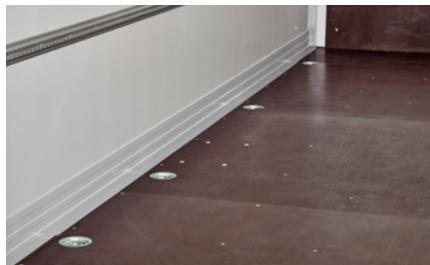
**Belastbarer Holzfußboden**, 15 mm stark, mit rutschhemmender und kratzunempfindlicher Oberfläche. Stabile, 60 mm hohe **Sockelscheuerleisten** schützen die Aufbauwände vor möglichen Beschädigungen durch das Ladegut.
