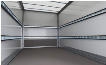
**Kombi-Ankerschiene** (KS51) oder **Airline-Schienen** (KS53) auf einer Höhe von 600 mm und 1.200 mm oder **Ladungssicherungsschienen** (KS59) auf 1.800 mm Höhe an den Seitenwänden zur flexiblen Transportsicherung.
